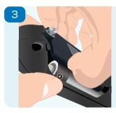
Le couvercle se soulèvera et, si nécessaire, la vis imperdable pourra être davantage desserrée afin que le couvercle puisse être complètement retiré.
