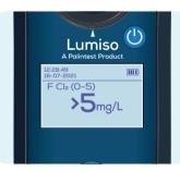
Si un résultat est supérieur à la plage de test, le symbole (>) s'affichera devant le résultat. Dans ce cas-là, il faudra diluer l'échantillon avec de l'eau désionisée et recommencer le test
