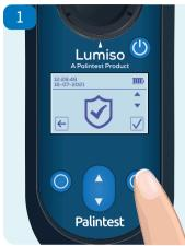
Vérifiez que le mode étalons de contrôle est accessible à partir du menu réglages (©)
