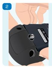
Le joint étanche intégré dans le couvercle de pile signifie qu'une force de traction ferme doit être appliquée pour le retirer.
