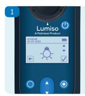
À partir du menu réglages ۞ Sélectionnez l'icône de l'ampoule - ☐ et confirmez ✓
