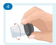
Durant le test d'échantillon ou l'initialisation, retirez toutes les bulles en bouchant le tube et en le tournant comme indiqué.
