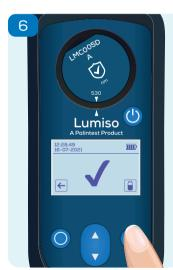
Insérez l'étalon A provenant de l'ensemble des étalons
