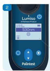
La ou les longueurs d'onde de la lumière utilisée par l'instrument sont indiquées en nanomètres (nm).
