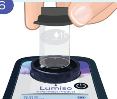
Assicurarsi che lo strumento Lumiso sia pulito e asciutto. Collocare le provette nello strumento con il rombo bianco allineato al segno sullo strumento.
