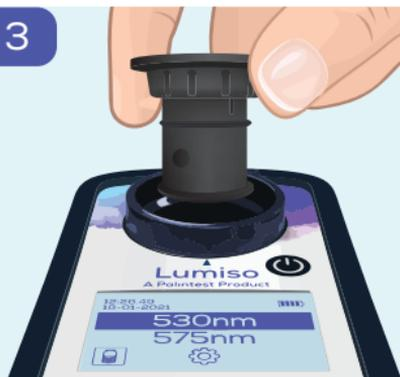
Per impostare il valore Blank (zero) per la lunghezza d'onda selezionata, utilizzare il blank che si trova all'interno del kit.
