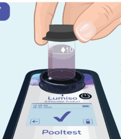
Preparare un campione di 10mL aggiungendo i reagenti secondo le Istruzioni del test. Collocare questa provetta nel vano apposito.
