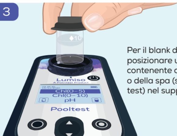
Per il blank dello strumento, posizionare una provetta contenente acqua della piscina o della spa (senza pastiglie per test) nel supporto della cella.
