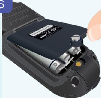
Riposizionare il coperchio, prima l'estremità della cerniera. Quindi spingere con fermezza il coperchio verso il basso finché non è parallelo al telaio come di seguito. Ciò garantisce che la tenuta stagna sia completa.
