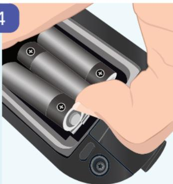
Le batterie sono tenute saldamente in posizione dalle clip per migliorare la resistenza di Lumiso agli urti fisici.
