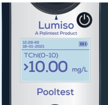
Se il risultato supera l'intervallo del test, davanti al risultato comparirà il simbolo '>'. In questo caso, sarà necessario diluire il campione con acqua deionizzata e ripetere il test **Importante: i test di pH e di alcalinità non sono adatti alla diluizione.**
