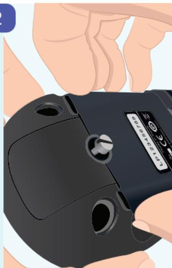
La tenuta stagna incorporata nel coperchio della batteria significa che è necessario applicare una forza di trazione decisa per rimuoverlo.
