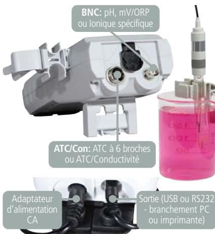
Les sondes de 12mm et 16mm peuvent utiliser le **support de fixation** pour fixer un ou plusieurs capteurs à un bêcher et à l'instrument, selon les besoins. Le support peut être étendu comme indiqué ci-dessus ou utilisé pour le montage mural.
